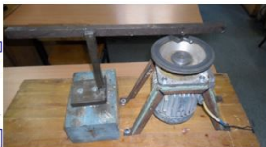
Рис.7. Вид установки для испытания на абразивный износ
